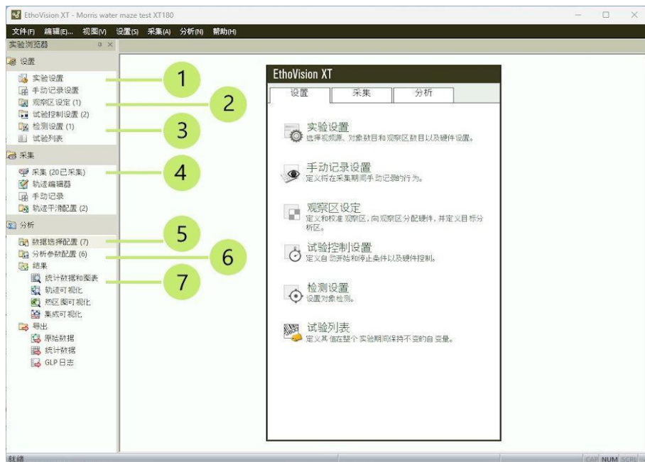
图1 实验的重要组成部分: 1.实验设置 (在整个实验过程中不会改变的基本属性)。2.观察区设定用于绘制观察区和分析区。3.检测设置用于检测摄像机图像中的观察对象。4.采集用于记录数据和视频。5.数据选择配置用于选择要分析的数据部分。6.分析参数配置用于指定输出变量（距离、速度等）。7. 结果选项。
